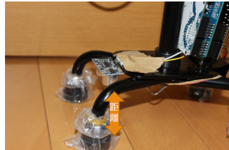
図 3 超音波センサーを取り付けた様子 Fig. 3 Fitted up with an ultrasonic sensor
