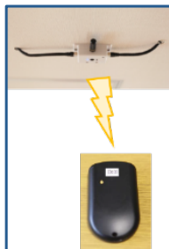
図 2 超音波位置センサの受信機 RECEIVER(上) と送信機 TAG(下)
