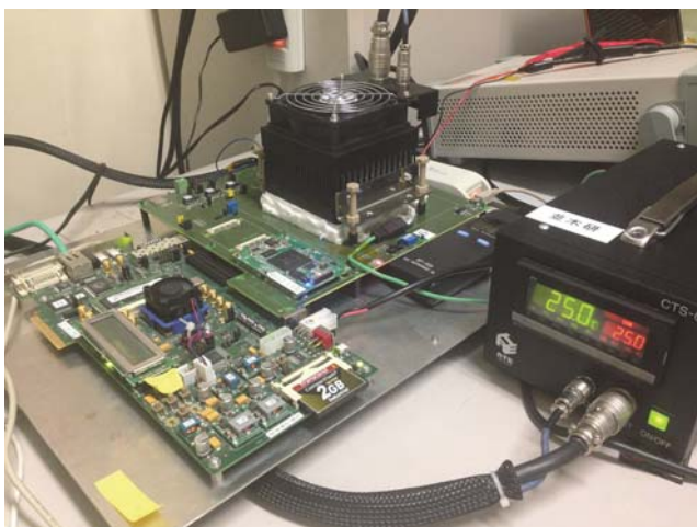
図 9 温度制御装置を取り付けた Geysler 評価ボード
