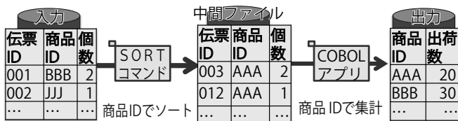
(b) 特定のキーを持つレコードの集計： 同一キーのレコード単位に処理を行う
