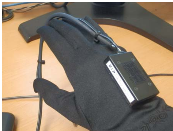
図 6 加速度, 角速度センサによる実験
