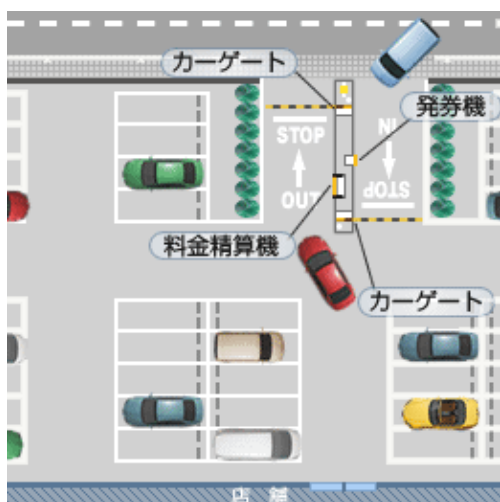
図 6 ゲート式駐車場
