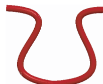
図 13 5 次のベジエ曲線で表現できないハーネス例
