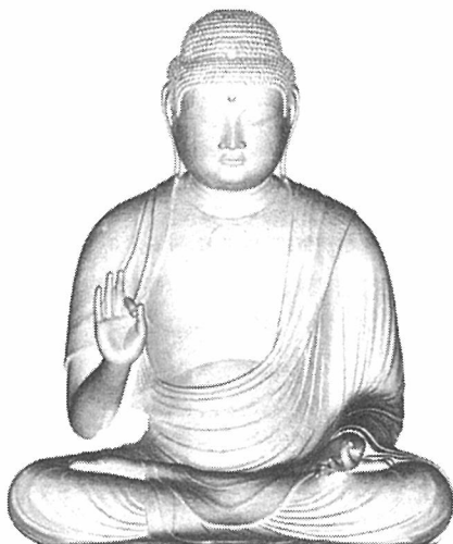
図6 正投影図（正面） 計算により見え隠れ部分の点群データを消去し、各々の点に含まれる方線情報を利用し軸方向の無限遠光源で点描によるシェーディング表示している。
