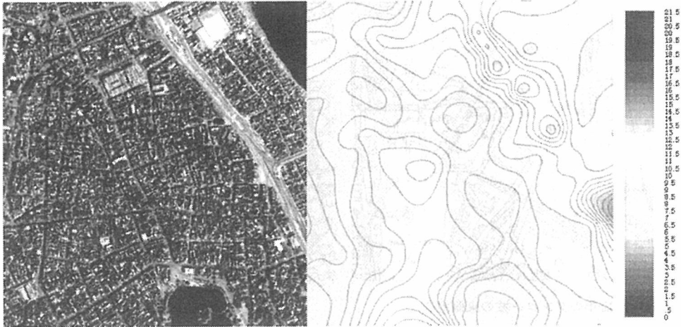
第9図 ホアンキエム湖周辺の2次元DEM (左はIKONOS画像, 右は作成したDEMで格子間隔2m, 等高線間隔は0.5m) .
