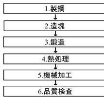
図 1 熱間自由鍛造品の製造工程
