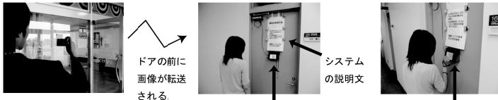
図3 プロトタイプシステムの外観。行き先を知らせるユーザは行った先でデジタルカメラのシャッターを押す(左図)。居室のドアの前には小型計算機が貼り付けられている(中央図)。訪問者は計算機の横にあるスタイラスを使って画像にらくがきをすることができる(右図)。
