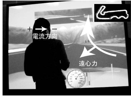
図 12 VR への GVS の応用 (遠心力方向と陽極方向が一致した順方向の図)
