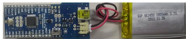
図4 Arduino Fio とリチウムポリマーバッテリー
