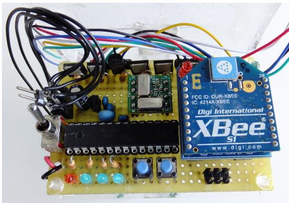
図 4 作製した回路基板
