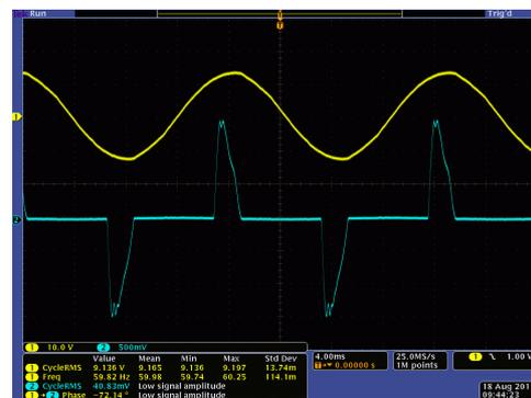
図 6 AC アダプタの電圧・電流波形
