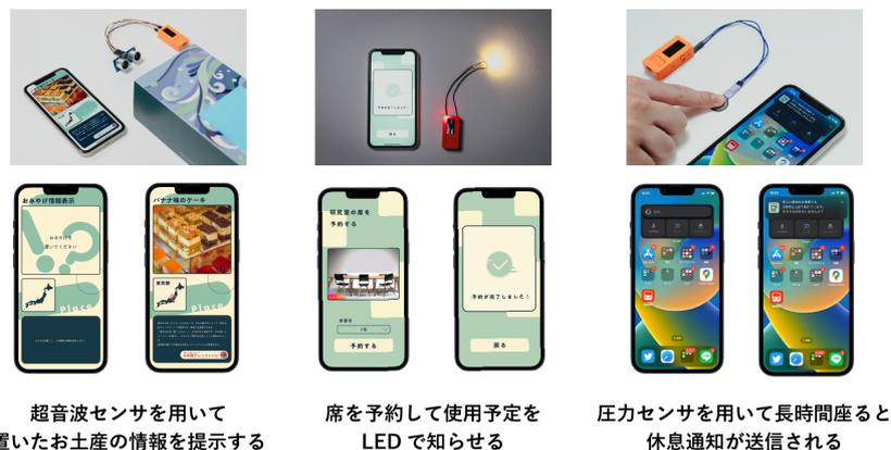
図 2 作成可能なプロトタイプ例. Figma で作成したクオリティの高い画面を、プラグインを用いてハードウェアと連携させることができる。
