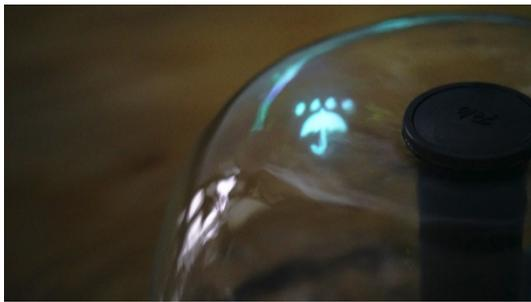
図 12 噴水面上に表示した空中像
