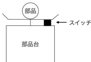
図 2 センサー設置状態例
