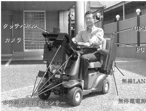
図5 高齢者向けユーザ搭乗型移動端末プロトタイプ ICW
