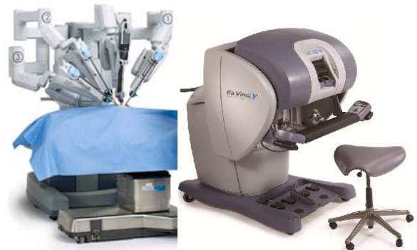
図1 Da Vinci (IS 社) の手術用アーム(左)と手術コンソール(右)
