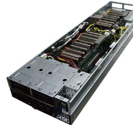
図 2 Thin 計算ノード HP Proliant SL390s G7 の外観 Fig. 2 Appearance of a thin compute node: HP Proliant SL390s G7.
