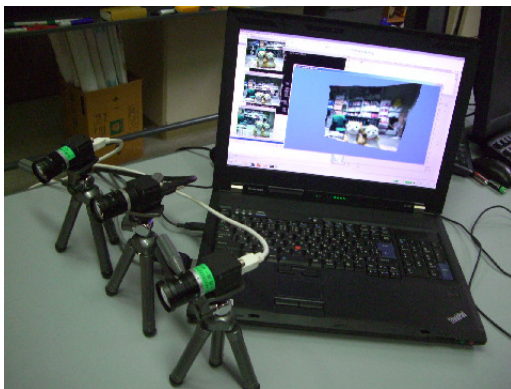
図 3 FTV システム. ノート PC 上で実装されている.
