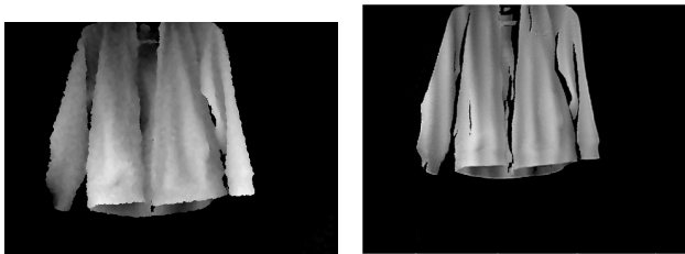
(c) Kinect による形状復元画像 (d) 信念伝搬型位相シフト法による形状復元画像
