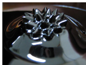
図2 磁性流体のスパイク現象（写真）
