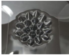
図 5 磁性流体表面の写真．表面において六角形のパターンが観察できる．
