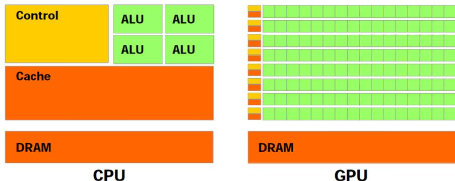
図 1 CPU と GPU のブロックダイアグラム
