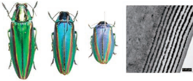
図-1 見る角度により色が変わるヤマトタマムシ(左)とその鞘翅断面の電子顕微鏡写真(右:浜松医科大学 針山孝彦氏提供). スケールバーは400nm.
