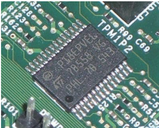
図-8 マザーボード上のTPMチップ(松本研究室撮影)
