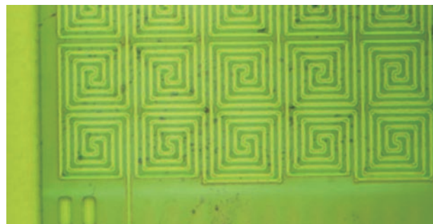
図-12 TPM の例：チップ表面が一筆書きのラインで覆われていて、メタル層が目視できない(松本研究室撮影)。
