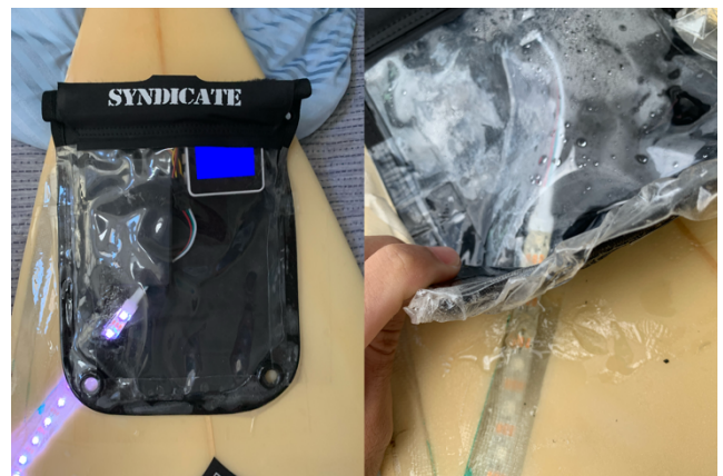
図 2 マイコンの防水処理
