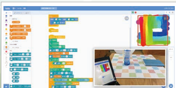
図-8 画面上の「バーチャル壁」と移動量による障害物検知を使った掃除ロボットのプログラム
