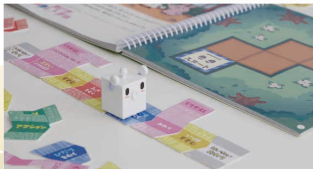
■図-5 toio の紙カード式プログラミングの例
