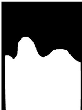
図 8 膨張 (Dilation) 処理直後
