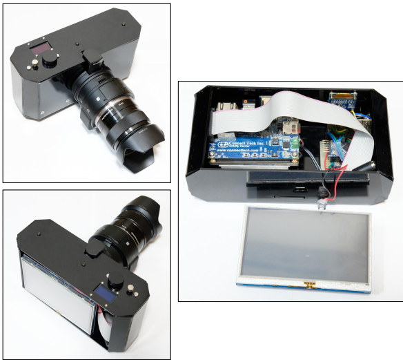
図 1 構図推薦カメラ本体. (上) 正面, (下) 背面, (右) 内部 Fig. 1 Composition recommendation camera. (Top) Front, (Bottom) Back, (Right) Inside.
