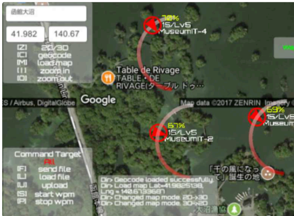
図1 複数台ドローンのモニタリングおよび命令送信画面
