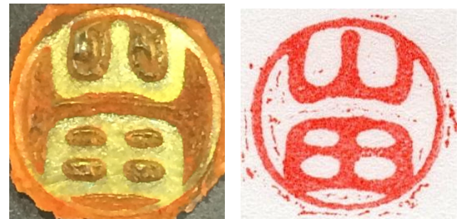
図 7 フォトリソグラフィを利用した偽造印章（左）とその印影（右）。
