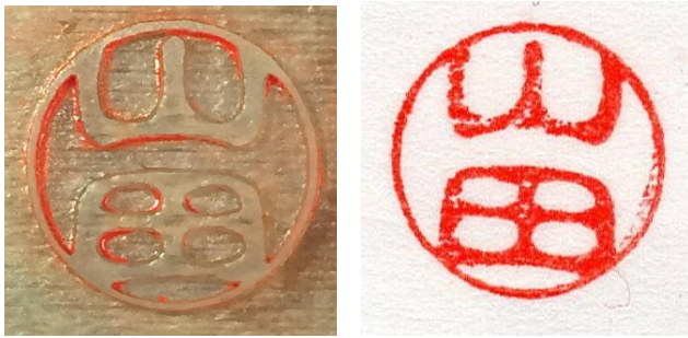
図 8 マテリアルジェッティング方式を利用した偽造印章(左)とその印影(右)。
