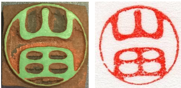
図 6 レーザー加工機を利用した偽造印章（左）とその印影（右）。
