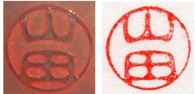
図 5 熱収縮現象を利用した偽造印章（左）とその印影（右）。
