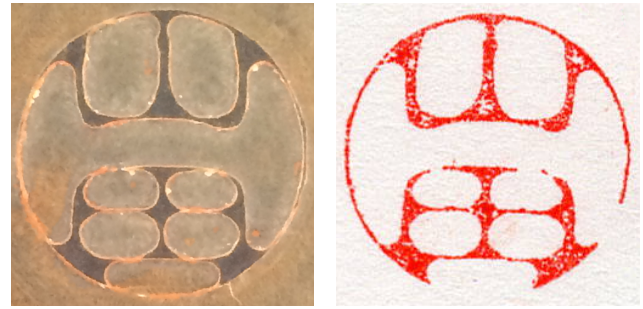
図 4 CNC フライスを用いて作成した偽造印章（左）とその印影（右）。
