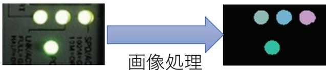
図 1 LED の点灯位置による状態認識の例
