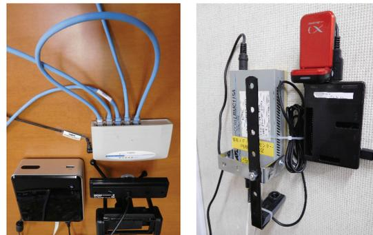
図 4 監視システム（右：メディアコンバータ監視システム、左：イーサネットスイッチループ検出システム）
