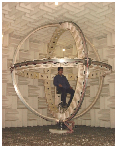
図 2 HRTF を測定するための球状スピーカアレイ
