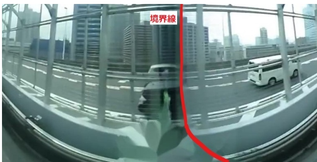
図 7 前後の半球画像の境界線を越える移動物体は消える。
