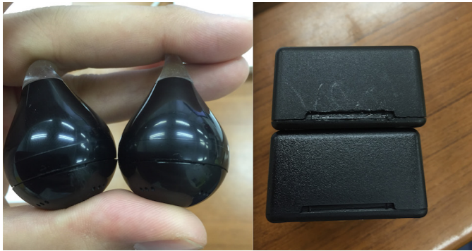
図 1 電池の出し入れによってビーコンにできた傷 (Braveridge 社, Aplix 社)
