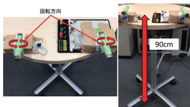
図 3 既存モータを用いて構築した磁場マーカ
