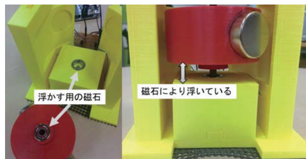
図6 磁石の浮遊機構
