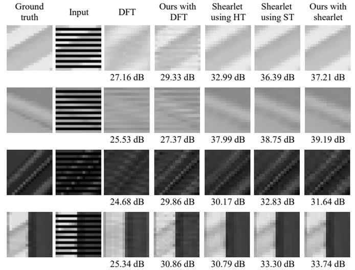
図 4: EPI 補間の結果 (HT は hard-thresholding, ST は soft-thresholding を表す.)
