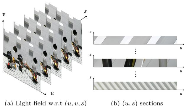
図 1: 光線空間とその 2 次元部分空間の直線構造
