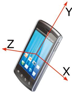
図 4 加速度センサの軸方向
