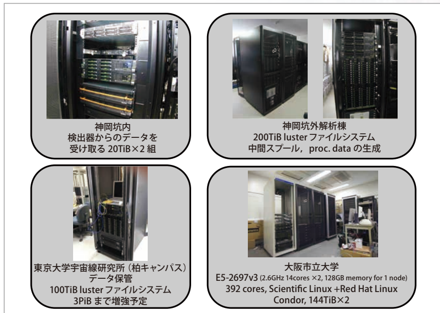
図-3 KAGRA の現在の主な計算機資源 (データ転送・保管システム, データ解析関連)
