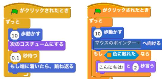
図 1 Scratch プログラミングの基本プログラム
