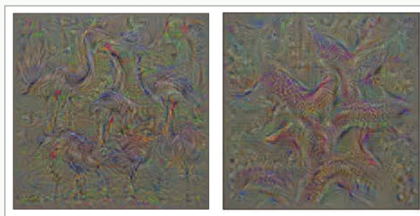
図-7 物体カテゴリ認識のための学習済みCNNに対し、その特定カテゴリ出力を最大化する入力画像。左: crane (ツル)。右: starfish (ヒトデ)。CNNが大域的な形を捉える能力があることを示す証左と言える
