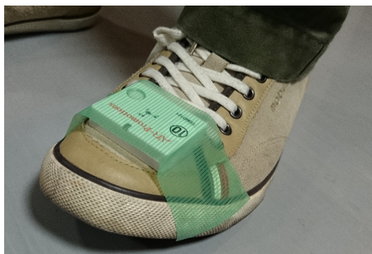
図 7 靴に装着された三軸加速度センサ
