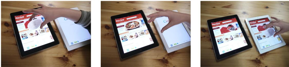
図 1 本方式による複数コンピュータ間情報移動. 左：複数指で情報をつまみ上げ，中：別のコンピュータに移動，右：画面に置く
