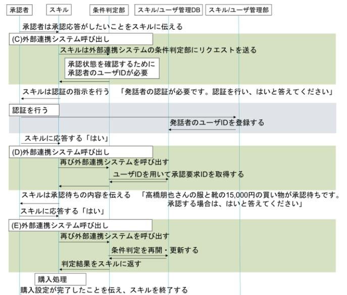
図8 承認応答時の外部連携システムの流れ
